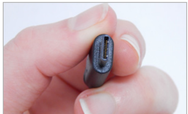
Der USB Typ C Stecker kann praktischerweise in beide Richtungen eingesteckt werden.
