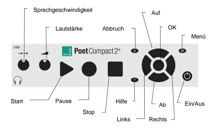
Das Vorlesesystem hat die Bedientasten und die Lautsprecher auf der schrägen Vorderseite, den Scannerdeckel auf der Oberseite, den Netzanschluss und die Transportsicherung an der Rückseite, Lüfter an der rechten Geräteseite und Unterseite.
