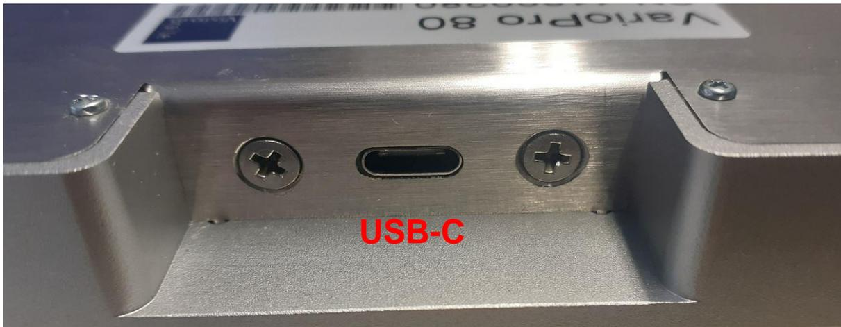
Die USB-C Anschlussbuchse (für die Verbindung mit einem Computer, Laptop oder Notebook) befindet sich ca. 2 cm eingelassen in einer Aussparung an der linken Gehäuserückseite.
