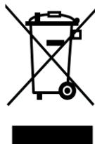
Das Symbol (durchgestrichene Mülltonne), das auch am Gerät angebracht ist (Typenschild), weist darauf hin, dass das Gerät und sein Zubehör nach Ende der Lebensdauer nicht über den Hausmüll entsorgt werden dürfen. Eine Umweltgerechte Entsorgung ist vorgeschrieben.
