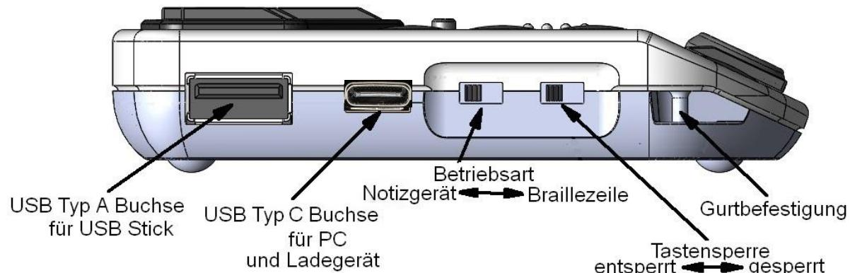
Auf der linken Geräteseite von VarioUltra befinden sich die USB Anschlüsse und zwei Schiebeschalter. Ausgehend von der linken, hinteren Ecke erreichen Sie:
